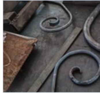
[1] Vor dem Schmieden war das Feuer: Rund tausend Grad soll die Glut in der Esse haben [2] Der Winkel muss passen: Max Schneider verwendet ein selbst gebautes Lehrwerkzeug [3] Sanfte Schläge für hartes Eisen: Es steckt Fingerspitzengefühl in der Schmiedearbeit
