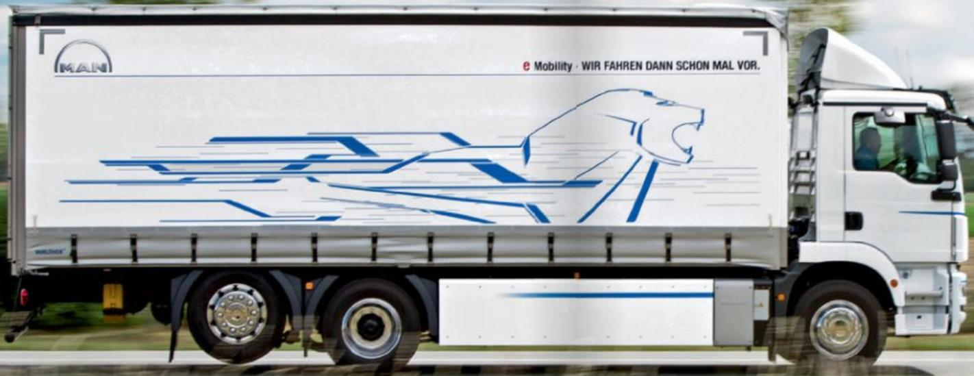
Bedarf abgedeckt: Der eTGM hat eine Reichweite bis zu 200 Kilometer. Das ist ausreichend für den Bedarf des Stadtlieferverkehrs mit etwa 120 Kilometern am Tag.
